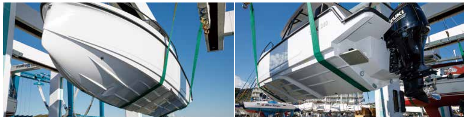
シングルアウトボードはSUZUKI DF300を搭載。パワーステムが逆傾斜した独特の形状の艇体で、深めのVハル、さらに深めのダブルステップが切られており、まるでパフォーマンスボートのようだ。
