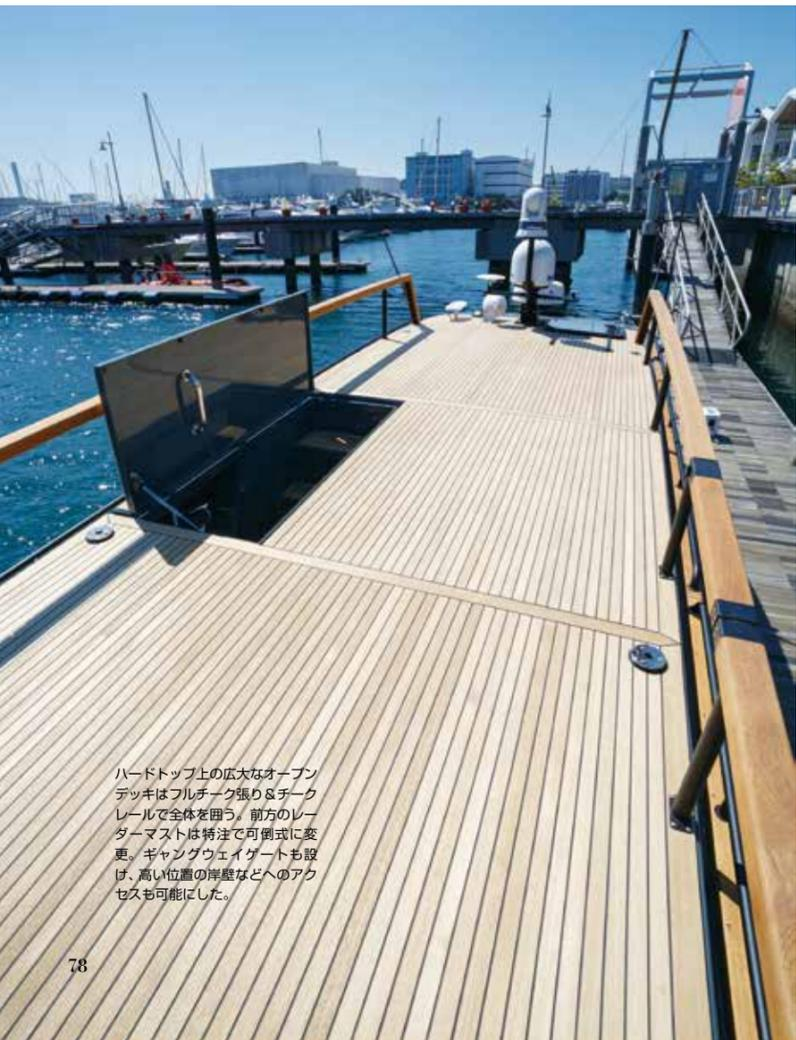
ハードトップ上の広大なオープンデッキはフルチーク張り&チークレールで全体を囲う。前方のレーターマストは特注で可倒式に変更。ギャングウェイゲートも設け、高い位置の岸壁などへのアクセスも可能にした。
