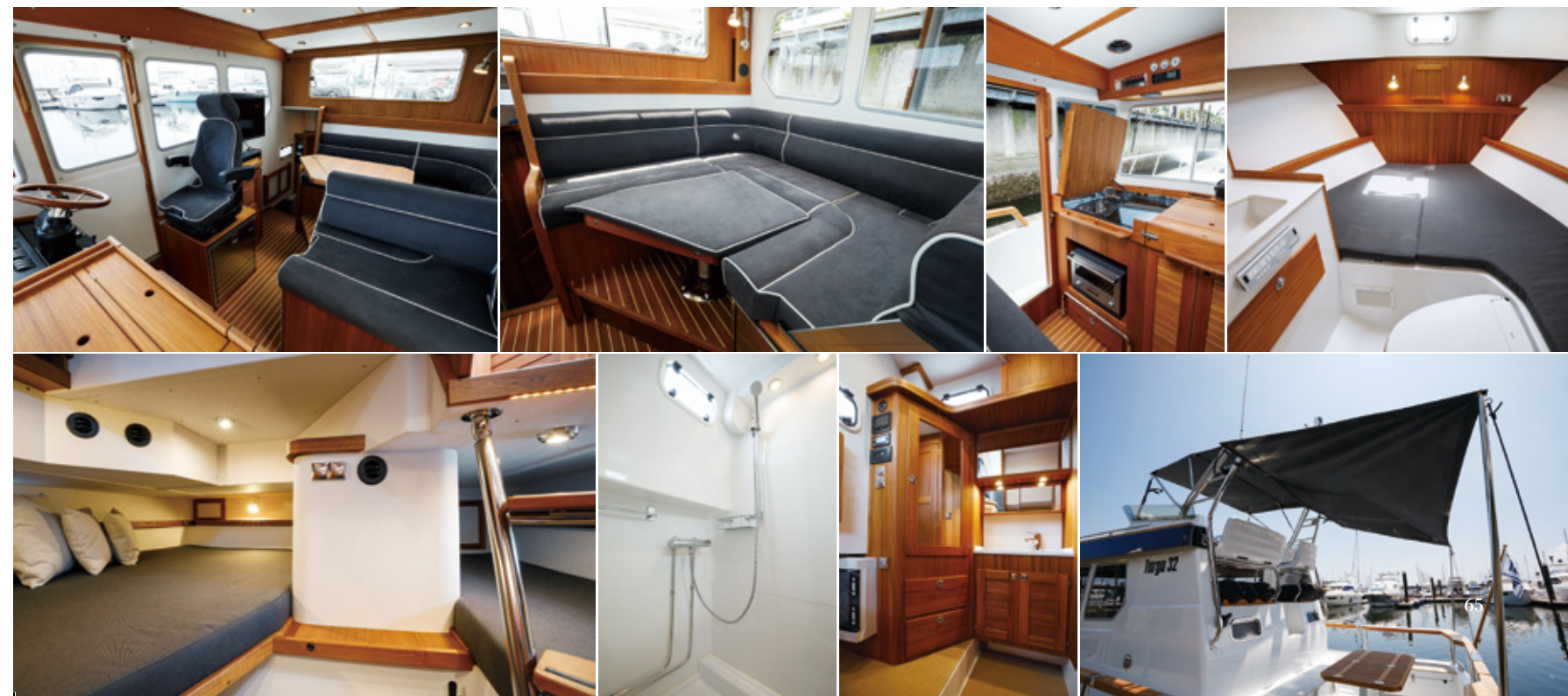
コンソールのポート側にはIH調理器と電子レンジが綺麗に収まるように造船所で造作。シンクは、フォアキャビンのVバースの一部を改造したもの。パワーバースにはトイレを設置し、アフトキャビンのトイレは外し、シャワー専用ルームに変更。
