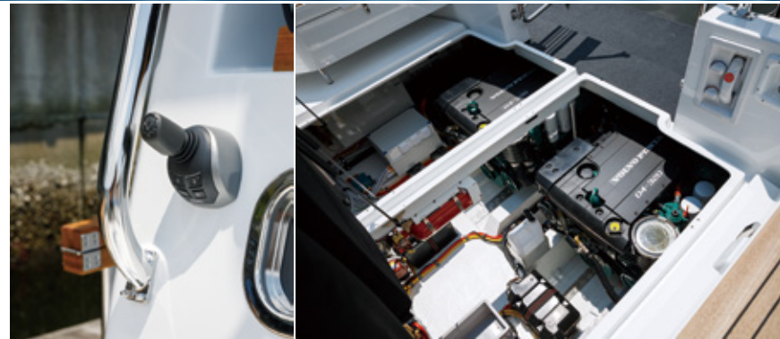
エンジンは静寂性の高い小型低燃費のVOLVO PENTA D4/DPI。320馬力仕様の4気筒3.7ℓ コモンレールディーゼルを2基搭載。キャビン内とフライブリッジの他に、アフトデッキのポートサイドにジョイスティックを追加。左舷の離岸も見やすい。
