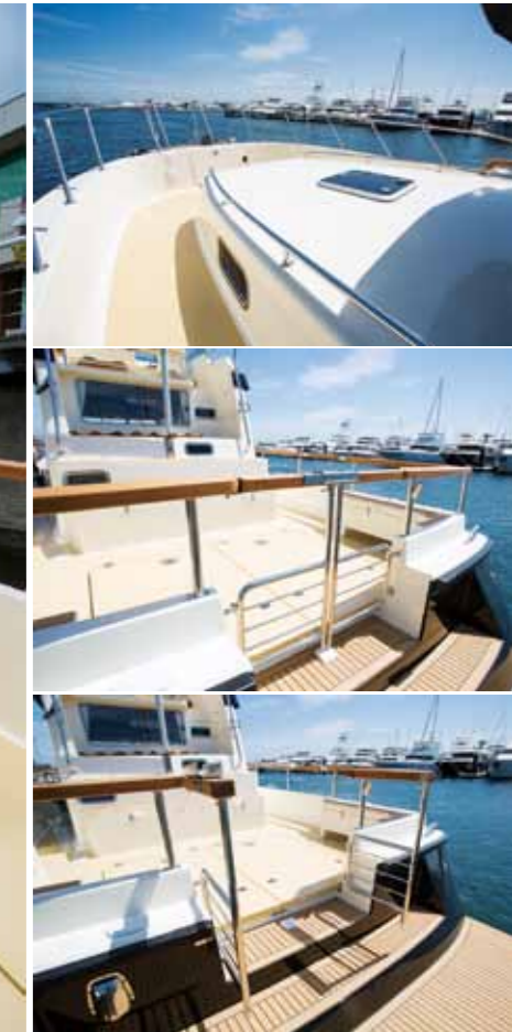
フライブリッジに上がるステップにはスリッパしづらいチークデッキが貼られている。1段目はアフトテーブルの座席、1〜3段目はアフトキャビンのヘッドクリアランスとポートライトハッチ。3段目は後方視界を妨げないフェンダーホルダー。4段目は大型のリアウィンドシールド。大型のチークテーブルはエンジンハッチ裏側の専用バックに格納できる。全てが機能的で無駄がなく、しかも美しい。
