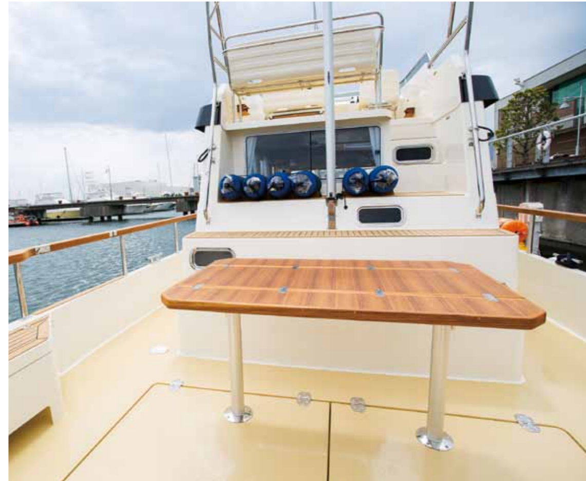
フライブリッジに上がるステップにはスリッパしづらいチークデッキが貼られている。1段目はアフトテーブルの座席、1〜3段目はアフトキャビンのヘッドクリアランスとポートライトハッチ。3段目は後方視界を妨げないフェンダーホルダー。4段目は大型のリアウィンドシールド。大型のチークテーブルはエンジンハッチ裏側の専用バックに格納できる。全てが機能的で無駄がなく、しかも美しい。
