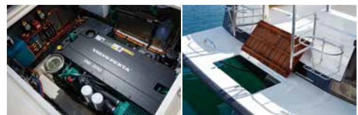
シングルエンジン、スターンドライブ仕様。取付艇はVOLVO PENTA D6-370を搭載。エンジンパリエーションはすべてVOLVO PENTA D6のシングルで、340馬力~440馬力に4モデルが用意される。トランスムプラットフォーム上の木製ハッチはインスペクションハッチで、洋上でも安全にチェックが行える。
