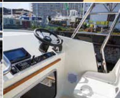
パイロットハウス両舷にスライド式のドア。ヘルム脇にドアがあるのでショートハンドでの離着岸も至ってしやすい。ドライバーとパッセンジャーシートは共に後ろ向きにしてテーブルを囲める。ダッシュボードにはミニギャレ、フォア側に個室ヘッド&シャワー、アフト側のステップからロアデッキに降りれば4名分のベッドスペースが確保されている。フルワークは丈の高いレールがセットされ、後部とサイドにアクセスゲート。コンパクトなフライブリッジは詰めれば大人3名が並べる。前後デッキも使いやすく、楽しいピクニックが期待できる。
