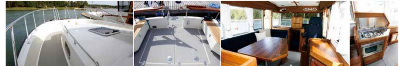
まるで家具のような暖かみあるウッドを基調としたインテリア。ヘルムのメーターや航海計器類は見やすく配置され、コンパクトなギャレーにはガスコンロにレンジも備わる。アウトサイドのフォアデッキは、フォアキャビンがCFC仕様のため、全体に高くなっている。デッキは全周ノンスリップ加工。滑りにくく、ウィンターブーツでも安全にデッキワークが行える。
