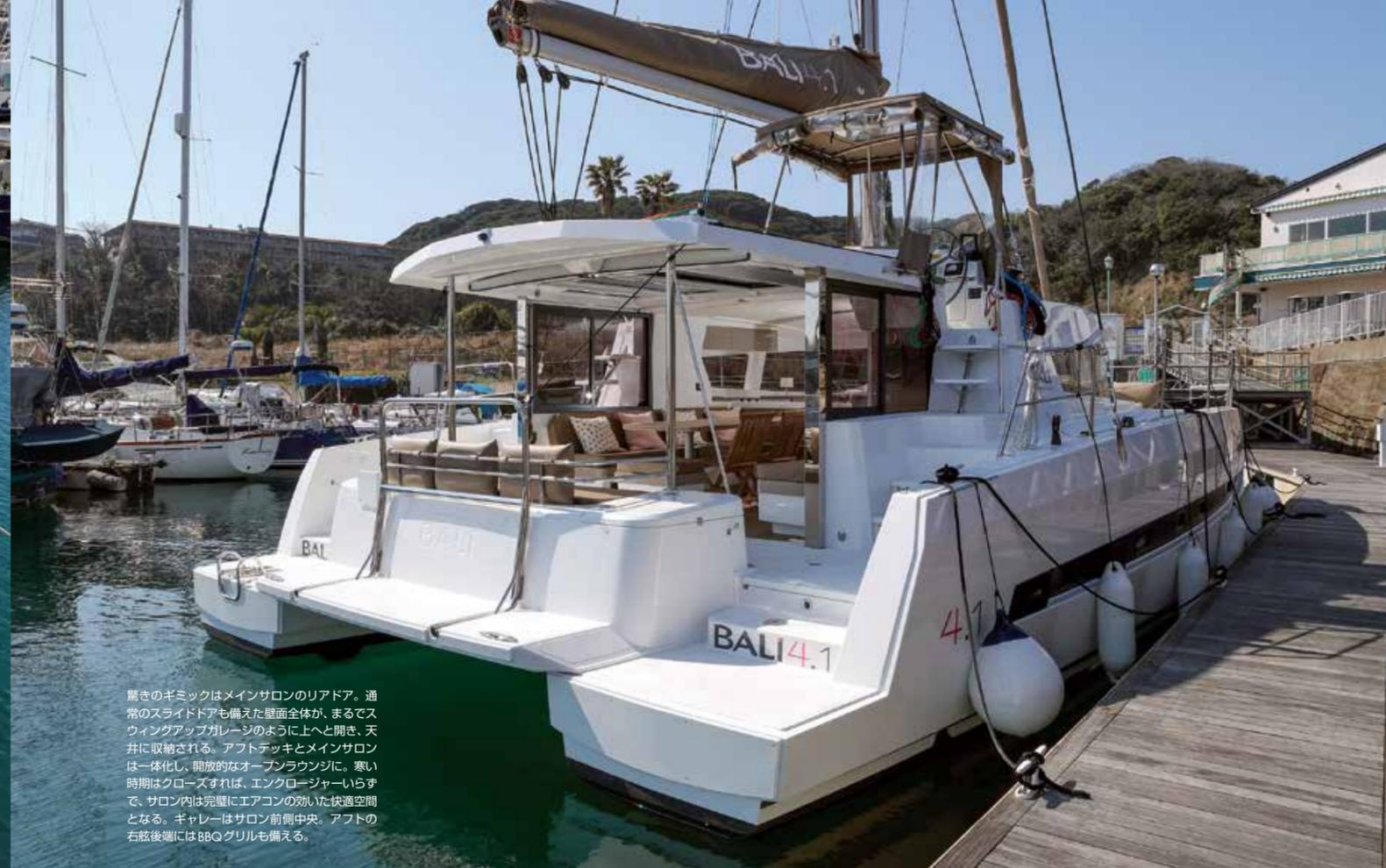
驚きのギミックはメインサロンのリアドア。通常のスライドアームも備えた壁面全体が、まるでスウィングアップガレージのように上へと開き、天井に収納される。アフトデッキとメインサロンは一体化し、開放的なオープンラウンジに。寒い時期はクローズすれば、エンクローチャーいらずで、サロン内は完璧にエアコンの効いた快適空間となる。ギャレーはサロン前側中央。アフトの右舷後端にはBBQグリルも備える。
